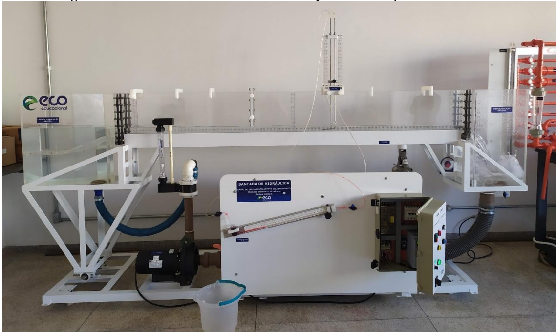
Figura 7.4 – Bancada hidráulica utilizada para calibração do fluxímetro.
