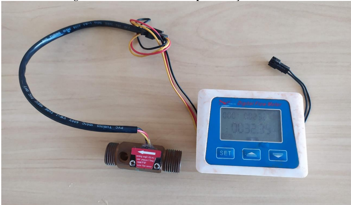
Figura 7.3 – Fluxímetro utilizado para medição de vazão.
