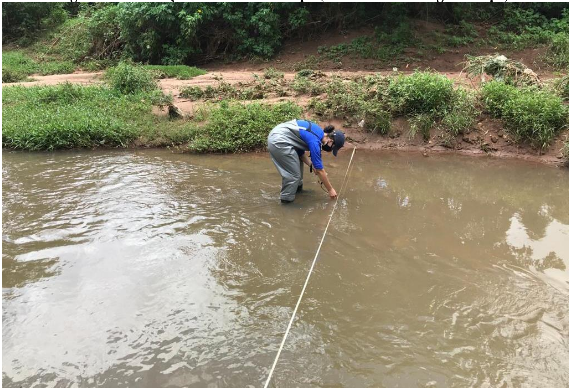
Figura 7.5 – Medição de vazão em campo (exutório do Córrego do Sapo).
